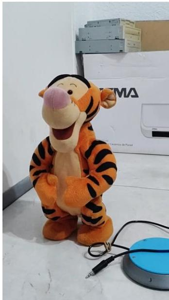
El tipo de pulsador elegido es del tipo de presión, para ser accionado por la mano, usado en diferentes soportes como una mesa, escritorio o en un soporte tipo pie. Está realizado externamente en plástico, con un switch de mouse para lograr un accionamiento suave. Dentro lleva conexión acorde y tuerca para ser ajustado al soporte pie, además de las sopapas que permiten adhesión a superficies lisas.
