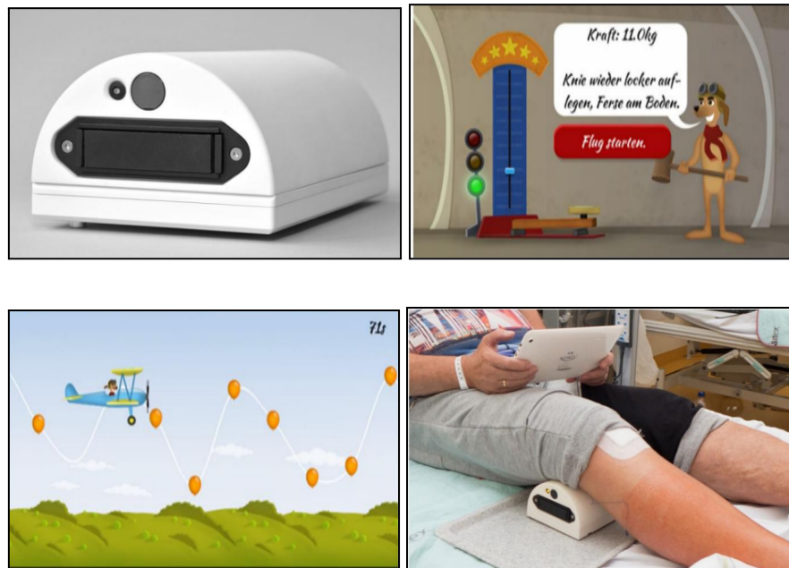
Figura 2. Arriba-izquierda, sensor del GenuSport. Arriba-derecha, programa de juego “golpe alto”. Abajo-izquierda, programa “simulación de lucha. Abajo-derecha, Paciente utilizando la tableta y el sensor. Extraídas del estudio de Bäcker et al. (50)
