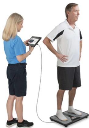
Figura 5. Set-up con la plataforma BTS para el registro de los desplazamientos del centro de presión corporal.
