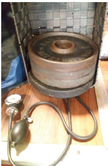
Imagen II. Calibración de esfigmomanómetro.
